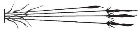
Acero Bajo C: Rayos blancos, longitud 1,5-2 m. Más chispas cuanto más C
