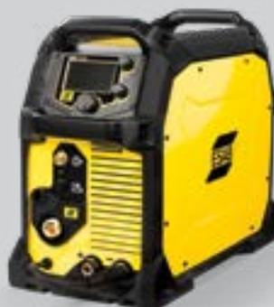
La **Rebel EMP 235ic** creada para una potente flexibilidad, acepta una alimentación de corriente de 90-270 V, ofrece una salida máxima de 240 A/30 V y pesa solo 24 kg. Acepta bobinas de 100, 200 y 300 mm y funciona con hilos sólidos de 0,6-1,2 mm e hilos tubulares de 0,8-1,2 mm.
