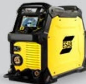
La **Rebel EMP 215ic** es la más ligera y portátil; esta unidad acepta una alimentación de corriente de 90-270 V, pesa apenas 21,5 kg y ofrece una salida máxima de 235 A/26 V. Acepta bobinas de 100 y 200 mm y funciona con hilos sólidos de 0,6-1,0 mm e hilos tubulares de 0,8-1,2 mm.
