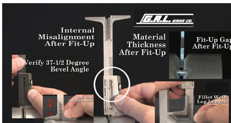
Mide la alineación o falta de alineación interna de una junta a soldar en tubería, tras la preparación de dicha junta, además de defectos o cortes en el interior del tubo.
