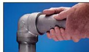
**3.** Cuando se ajusta el tubo queda asegurado que se respeta la separación mínima para soldar de 1,6 mm, según los códigos ANSI 31.1 Sección III, ASME y Militar
