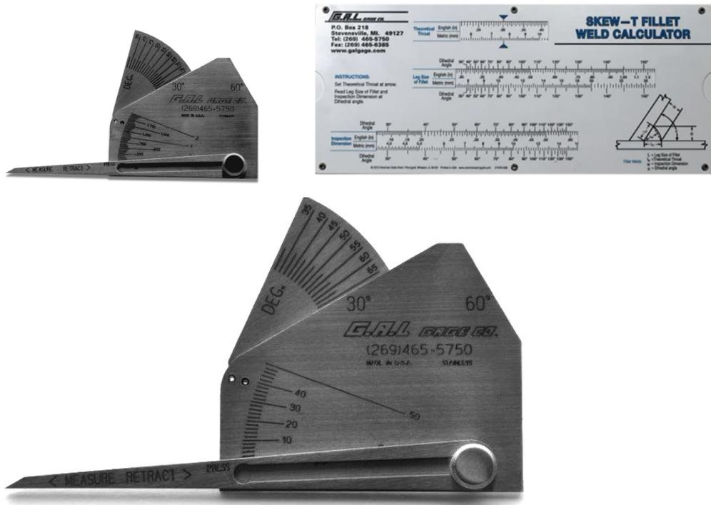
Se entrega con una tabla calculadora que permite la realización de todos los cálculos de ángulos de encuentro y tamaño de los fillet que se deben realizar para completar las juntas.
