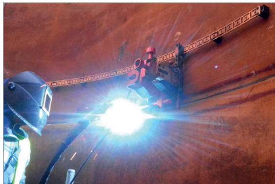
Raíl flexible de longitud 185cm (6ft) 1pc Radio mínimo de curvatura de 1.0 m (3.3 ft) PRW-0466-50-01-01-0
