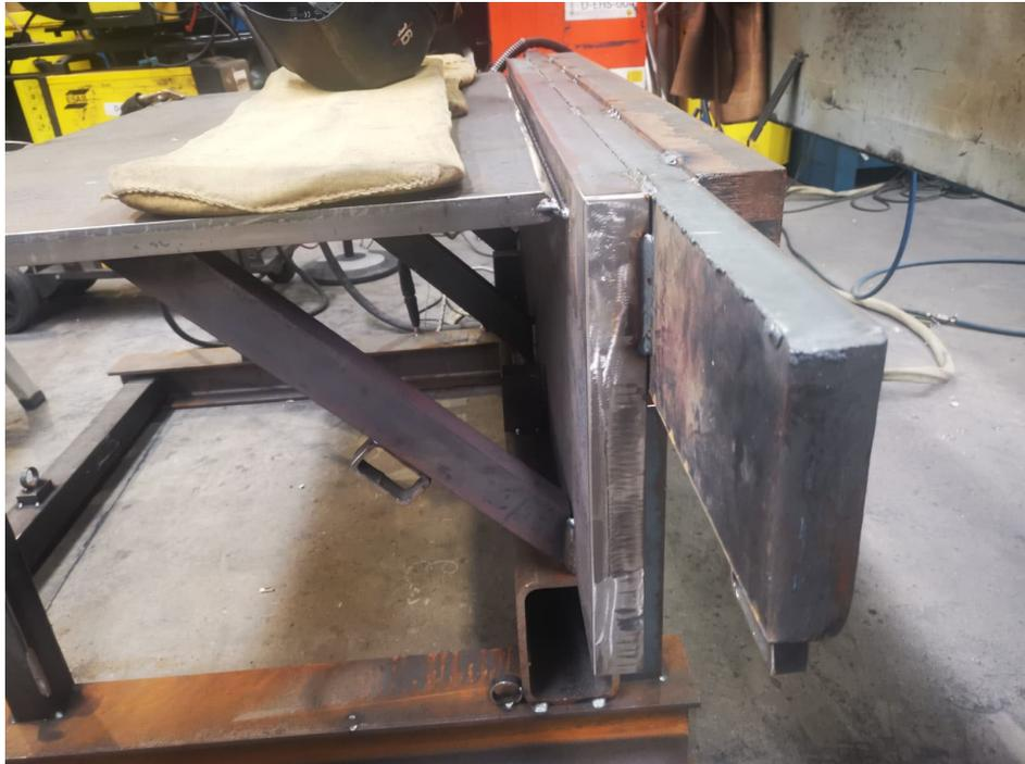
4. Calentamiento componentes de gran espesor para fabricación puente – ACCIONA – Junio
